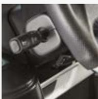
**Leva regolazione altezza volante.** Posta sotto il piantone dello sterzo, se azionata permette di regolare l'altezza e la lunghezza del volante in funzione delle preferenze del conducente. Al termine della regolazione riportare la leva nella posizione di blocco del piantone.
