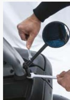
Per il corretto posizionamento degli specchietti retrovisori è necessario regolare l'inclinazione della superficie riflettente a seconda delle esigenze del conducente. Occorrono una chiave da 17mm, una brugola da 4 (in dotazione) e una 13mm. Con la 17mm si regola la rotazione avanti e indietro. Con la chiave da 13mm si regola l'inclinazione della lente riflettente. Con la brugola da 4 si regola l'altezza della lente.
