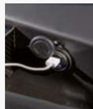
**Preso di carica USB.** La presa di carica USB, posta sul lato passeggero, viene attivata azionando il pulsante integrato. È possibile caricare, ad esempio, due dispositivi simultaneamente. La capacità di carica è di 2.1 Ampere per canale. La presa è funzionante anche se il veicolo è in modalità "OFF" (escluso veicoli street con batterie litio).
