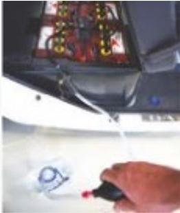
Inserire la controparte nel connettore di ricarica lato batterie. Premere e rilasciare ripetutamente il polmone pompetta per introdurre acqua demineralizzata nelle batterie. Continuare a pompare fino a che non cambia la consistenza e non si riesce più, di conseguenza, ad introdurre acqua demineralizzata nel sistema di ricarica. Scollegare il tubo di ricarica e reinserire il cappuccio del connettore lato batterie.
