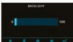
**Backlight:** selezionando questa voce e premendo il tasto sottostante al segno di spunta si entra nel menu di regolazione della retroilluminazione. È possibile selezionare una percentuale da 0% a 100% di intensità luminosa del display agendo sui comandi a freccia in su e giù del display. È possibile tornare al menu principale premendo il tasto sotto il simbolo della cassetta.
