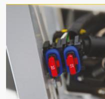
Nella versione dotata di fari (accessorio), sono presenti i fusibili a protezione dell'impianto di illuminazione e del 12V prodotto dal convertitore DC-DC (si possono controllare nel vano 5 di pagina 28). Entrambi i fusibili sono da 10A e di colore rosso.
