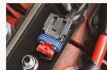
La versione non dotata di fari (accessorio), prevede un fusibile nella area batterie, visibile nell'immagine a lato. Tale fusibile è a protezione del ramo che alimenta la presa USB, la taglia è di 10A ed il colore è rosso.
