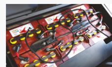
Se il veicolo è dotato del sistema di riempimento automatico, come da immagine sottostante, è sufficiente collegare il tubo di ricarica ed introdurre acqua demineralizzata.
