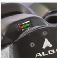
**Indicatore di carica.** Visualizza lo stato di carica delle batterie attraverso 10 settori colorati:
