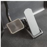
**Pedale freno.** È presente una ridondanza sul pedale freno. In caso di emergenza, premendo il pedale freno la trazione viene disabilitata.
