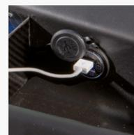
**Presenza di carica USB.** La presa di carica USB, posta sul lato passeggero, viene attivata azionando il pulsante integrato. È possibile caricare, ad esempio, due dispositivi simultaneamente. La capacità di carica è di 2.1 Ampere per canale. La presa è funzionante anche se il veicolo è in modalità "OFF".
