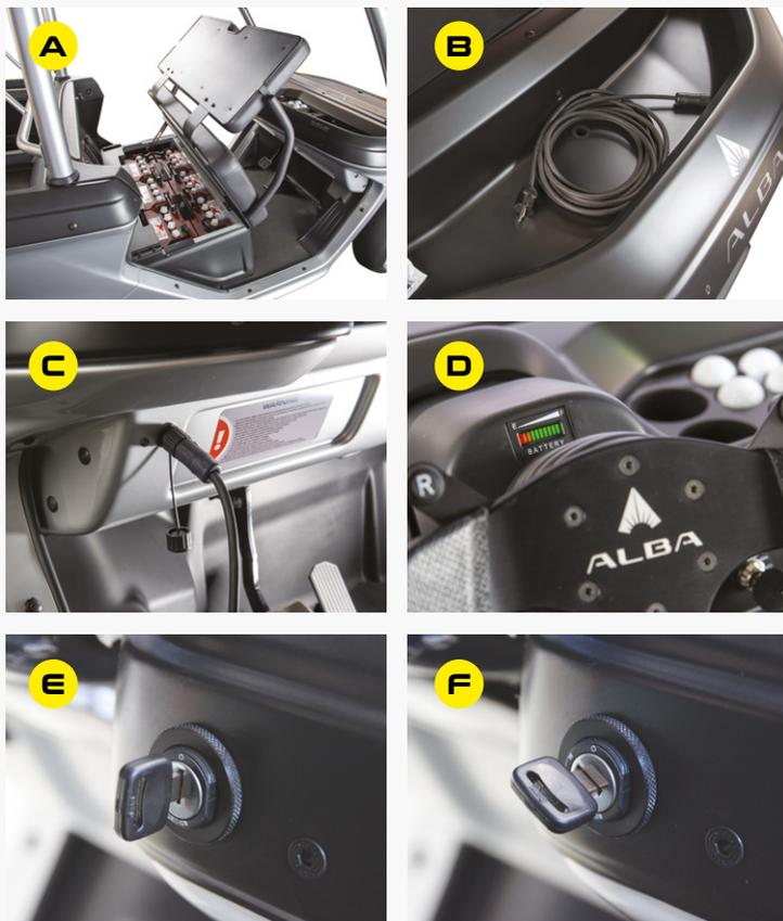
Il pacco batterie è posto sotto la seduta, per accedervi alzare la parte posteriore del sedile fino al raggiungimento della posizione di blocco (foto A).
